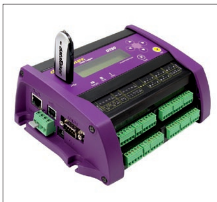
Obr. 2. Záznamník dat DT80 s externím paměťovým diskem
